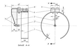
Abb. 2: Hellfeldbeleuchtung für einen Refraktor. 1= federnder Tragring mit etwas kleinerem Durchmesser als die Taukappe; 2= Miniaturglühlämpchen; 3= Steg aus 0.3 mm Messingblech; 4= Klötzchen aus Isolierstoff; 5= Anschlussbuchsen für Bananenstecker; 6=2.5 mm-Cu-Nieten; 7= zentraler Stromzuführungsdraht.
