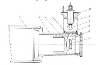
Abb. 1: Schnittzeichnung eines Fadenkreuzokulares mit Strichplatte und Dunkelfeldbeleuchtung. 1= Fernrohrauszug; 2= Okularsteckhülse; 3= Strichplattenfassung; 4= Schlitze in Okularsteckhülse und Okulartubus für den Lichteintritt; 5= Strichplatte; 6= Schlitz in der Strichplattenfassung; 7= Rotfilter; 8= Lampe; 9= Lampenfassung; 10= Isolierring.
