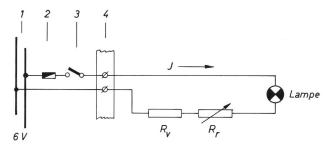
Abb. 4: Schaltungsanordnung einer Fadenkreuzbeleuchtung. 1 = Sammelschiene des Teleskopnetzes; 2 = Sicherung, entsprechend maximalem Lampenstrom dimensioniert; 3 = Schalter; 4 = Klemmenleiste; I = Lampenstrom.
