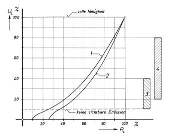
Abb. 5: Spannungsabhängigkeit des Innenwiderstandes von Kleinglühlampen. 1= Widerstandscharakteristik einer 6 V/20-Watt-Glühlampe; 2= Widerstandscharakteristik einer 6 V/1-Watt-Glühlampe (für andere Lampenleistungen ist zwischen den beiden Kennlinien zu interpolieren); 3= Arbeitsbereich für Fadenkreuz- und Teilkreisbeleuchtungen; 4= Arbeitsbereich für Leselampen, Instrumentenbeleuchtungen und indirekte Kuppelbeleuchtungen.
