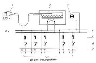
Abb. 3: Schaltungsschema eines Teleskopnetzes mit Kleinspannung. 1 =Schuko-Stecker für 220 V-Netzanschluss; 2 =Kleinspannungs-Schutztransformator für 6 V; 3 =Betriebssignallampe; 4 = 6 V-Sammelschiene des Teleskopnetzes; 5 =Sicherungen, entsprechend den maximalen Verbraucherströmen dimensioniert; 6 =Schalter für die einzelnen Verbraucherkreise; 7 =Klemmenleiste.
