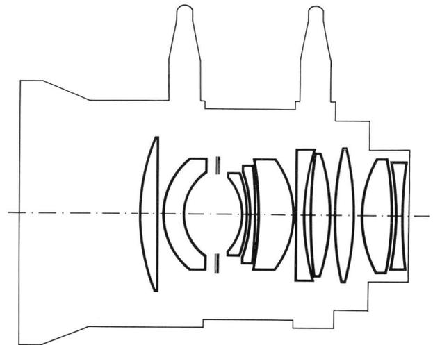
Optischer Aufbau des Switar 1:0.9/ $f = 18$  mm, das durch hohe Lichtstärke, grosses Auflösungsvermögen und hervorragende Korrektion gekennzeichnet ist.
