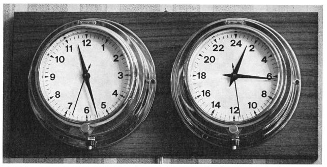
Fig. 1: Die neue Sternzeituhr «Synastrom» (Doppeluhr nach E. Esclangon, Weltzeit und Sternzeit gleichzeitig anzeigend), Ausführungsform für Amateursternwarten, Anschluss an 220 V, 50 Hz (Netz oder Quarzoszillator).
