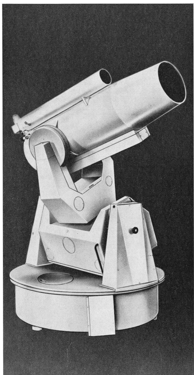
Das Gerät dient der genauen fotografischen Positionsbestimmung künstlicher und natürlicher Himmelskörper in bezug auf das Fixsternsystem. Es ist dazu mit folgender SCHMIDT-Optik ausgerüstet: Brennweite 780 mm, Durchmesser des Hauptspiegels 530 mm, Durchmesser der Korrektionsplatte 425 mm. Das gegebene Bildfeld hat einen Durchmesser von 155 mm.
