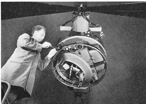
Abb. 4: Arbeiten an der Einrichtung zur Darstellung des Vertikal- und Stundenkreises.
