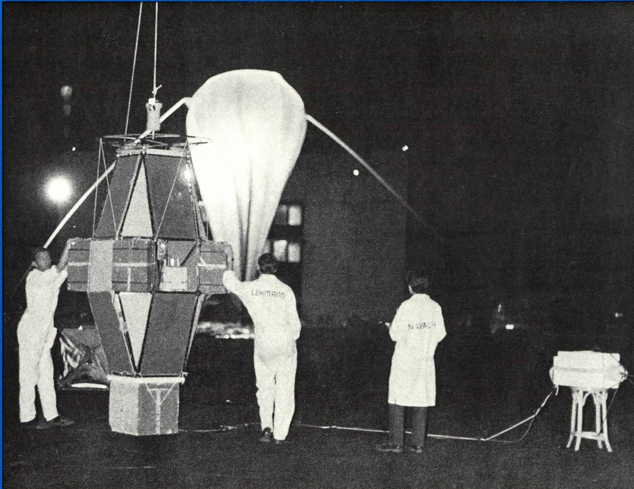
*Activités spatiales à l'Observatoire de Genève:* La nacelle, complètement équipée, sur l'aire de lancement. On peut voir l'amortisseur inférieur (caisson en sagex) et, à droite, l'émetteur de télémesure. Voir aussi article en page 3 de ce fascicule.
