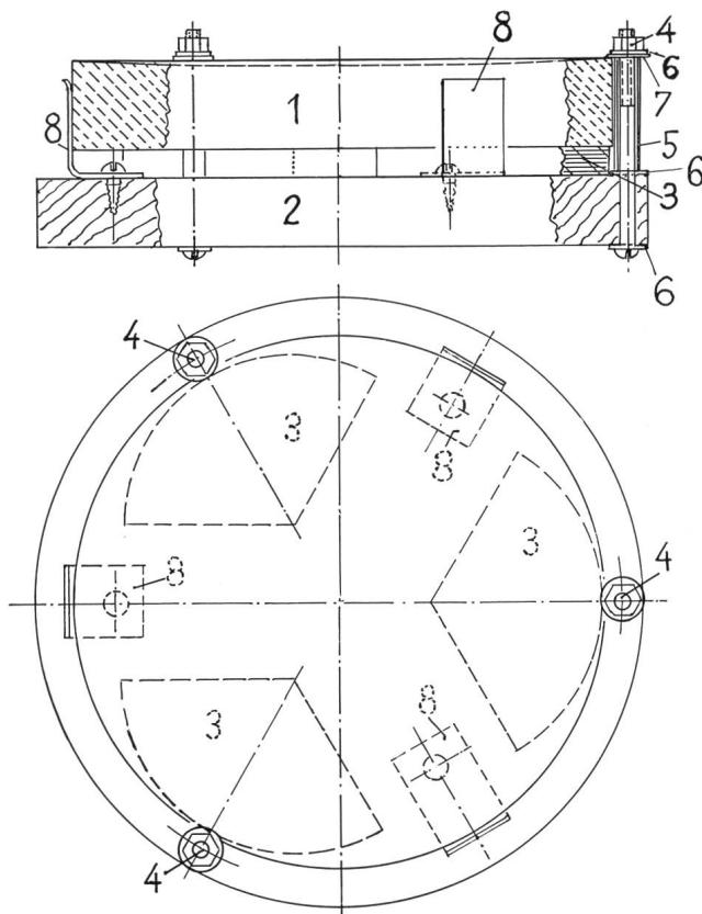
Legende: 1 = Spiegel ø 150 mm; 2 = Spiegelträger (Tischlerplatte); 3 = Korkunterlagen, auf 2 aufgeleimt; 4 = Spiegel-Halteschrauben, Messing; 5 = Distanzröhren, Messing; 6 = Unterlagscheiben, Messing; 7 = Unterlagscheiben, Fiber; 8 = Haltebügel, 1 mm galv. Blech.
