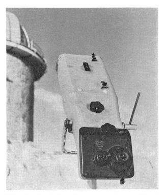
Bild 2: Das Fernrohr Somet-Binar 25 × 100, mit dessen Hilfe auf dem Skalnaté Pleso und auf der Lomnitzer Spitze 18 neue Kometen entdeckt wurden. – Aufnahme: M. ANTAL.
