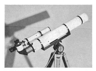
Kleines Linsenfernrohr (Vergrösserung bis  $100 \times$ ) auf Geometerstativ mit Kino-Stativkopf zur leichten Ausrichtung auf das Objekt. Der damit gezeigte Sucher (f = 30 cm, 8 bis  $20 \times$ )<sup>4</sup>) und das Zenitprisma können, ebenso wie eine einfache parallaktische Montierung<sup>4</sup>), später hinzugefügt werden.
