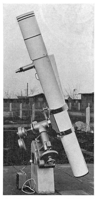
Fig. 1: Der 200mm-Refraktor des Münchner Sternfreundes Günther Nemec (Optik von D. Lichtenknecker). Um bei 4 Meter Brennweite des Objektivs die Baulänge zu reduzieren, wurden in das Rohr 2 Planspiegel eingebaut, womit dessen Länge auf etwa 2 Meter reduziert werden konnte. Der Einblick erfolgt seitlich, wie bei einem Newton-Teleskop. Mit diesem Instrument sind hervorragende Mond- und Planeten-Aufnahmen erhalten worden.
