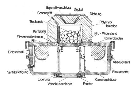
Fig. 1: Schnittzeichnung der Tiefkühl-Kamera
