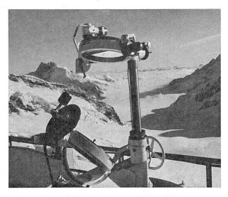
Le cœlostat, installé sur la terrasse supérieure de l'observatoire du Sphinx. Il envoie la lumière solaire vers le spectrographe situé dans un laboratoire au premier étage. – Derrière, le glacier d'Aletsch
