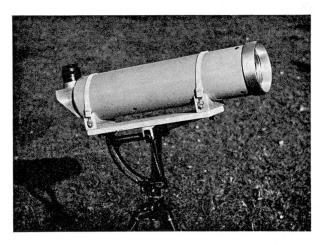
Abb. 2: Kometensucher von 12 cm Öffnung und 20facher Vergrösserung bei 4° Bilddurchmesser. Optik von Jaegers, Lynbrook, N.Y./USA.
