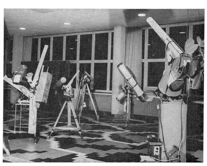
statt verschraubt zu werden, mit Araldit geklebt werden können. Die Klebestellen halten fast so fest wie das Metall selber, sodass diese einfache, billige und solide Konstruktionsweise jedem Amateur wärmstens empfohlen werden kann.
