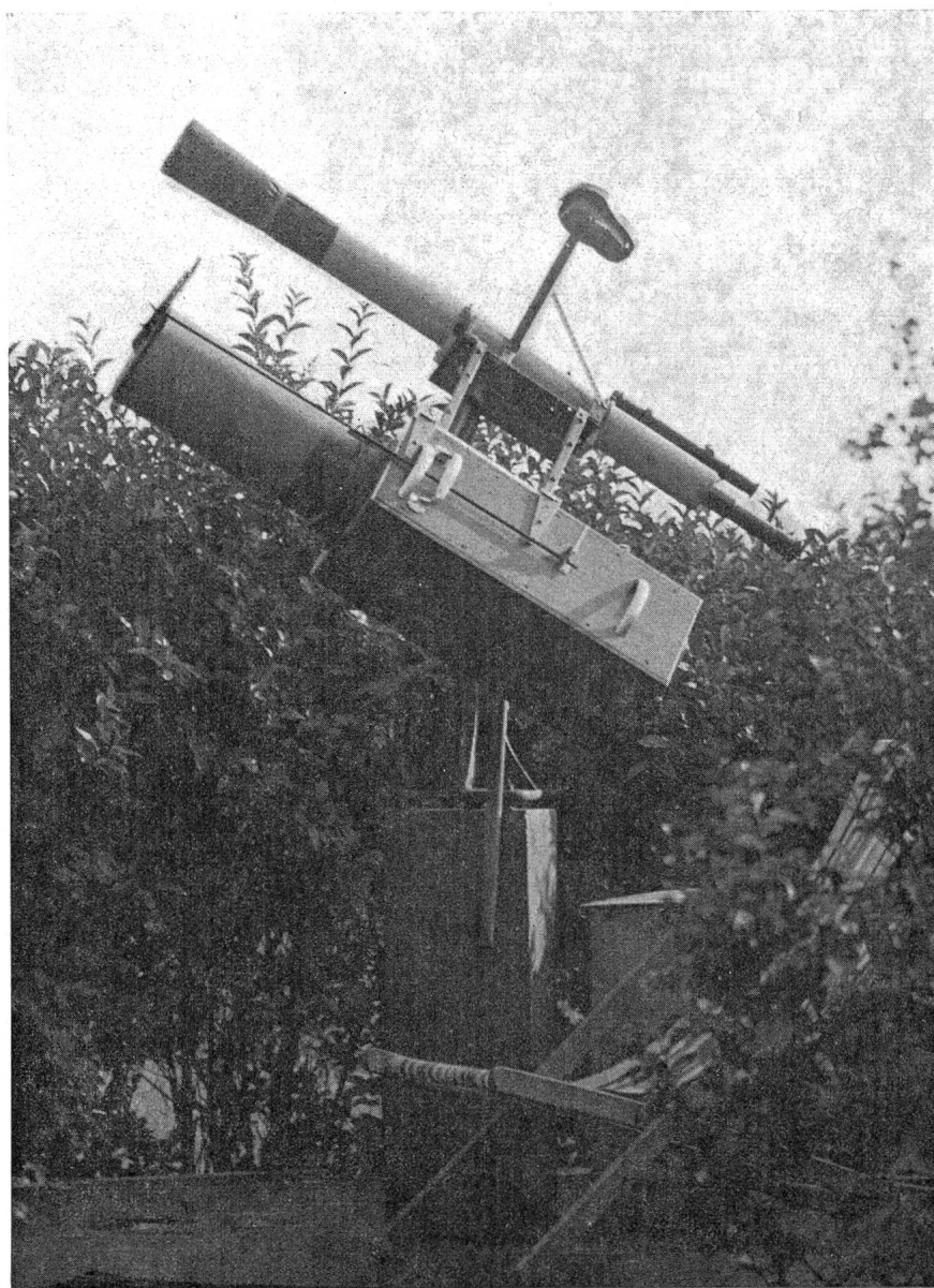
Fig. 1: Equatorial photographique d'amateur. Réfracteur-guide de f = 900 mm, D = 60 mm. Chambre photographique VOIGTLÄNDER de f = 600 mm, D = 133 mm.
