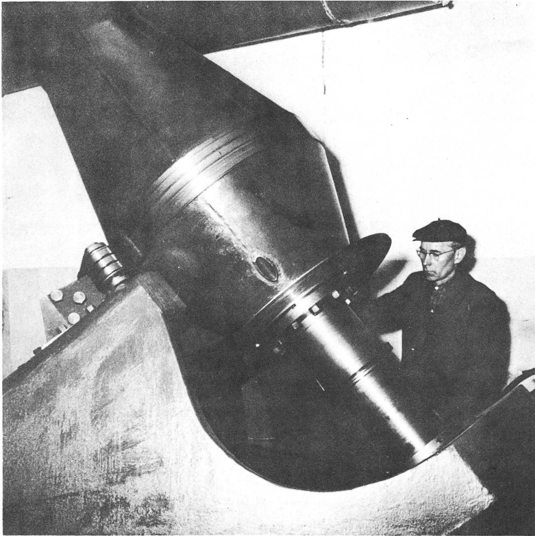
Abbildung 2: Eingebaute Polachse (Gewicht 2 Tonnen) für das 105 cm-Teleskop, mit seinem Erbauer V. Erhart.
