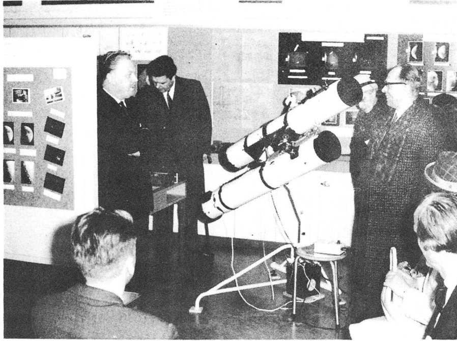
Abbildung 3: Von einem Mitglied gebautes Zwillings-Instrument mit Batteriebetrieb. Motor steuerbar durch Transistor-Oszillator; hinten: mit diesem Gerät gemachte Astro-Aufnahmen.
