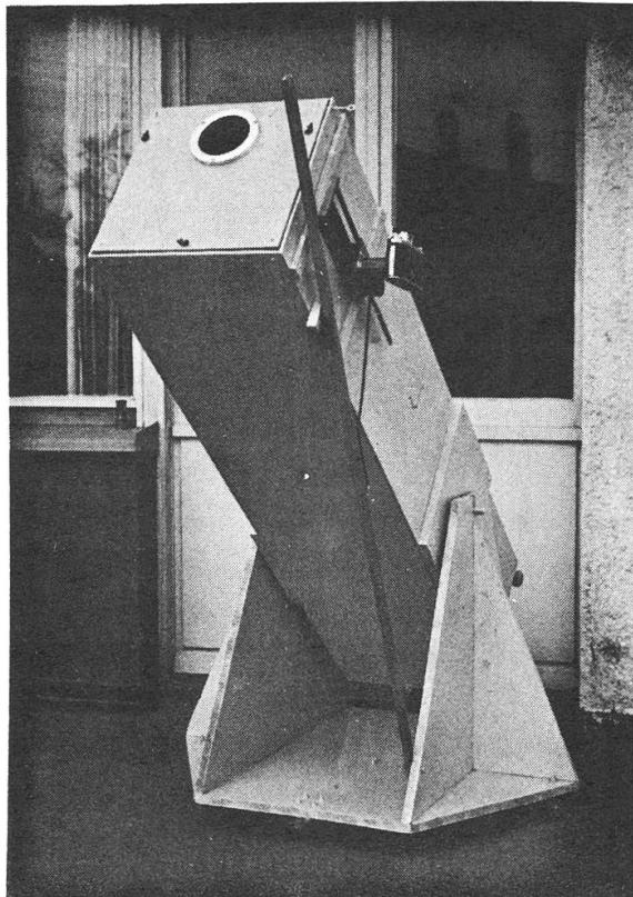
Ein Protuberanzenteleskop von 7,5 cm Oeffnung und 165 cm Brennweite für visuelle und photographische Beobachtungen. Eine Beschreibung dieses Instruments erfolgte im «Orion» Nr. 78/1962.
