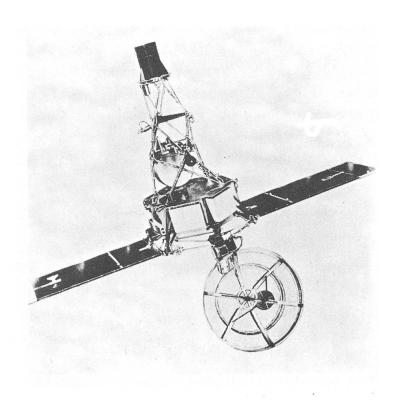
Abbildung 2: Venussonde «MARINER I», die gleich gebaut war wie «MARINER II». Die Flächen mit den Sonnenzellen sind ausgebreitet.
