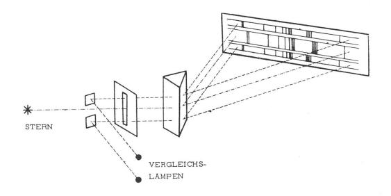
Abbildung 1: Spektrograph (Schema). Durch zwei kleine Spiegel wird das Licht von zwei Vergleichslampen parallel zum Licht des Sternes in den Apparatgeworfen, sodass zu beiden Seiten des Sternspektrums je ein Spektrum der Vergleichslampen entsteht.
