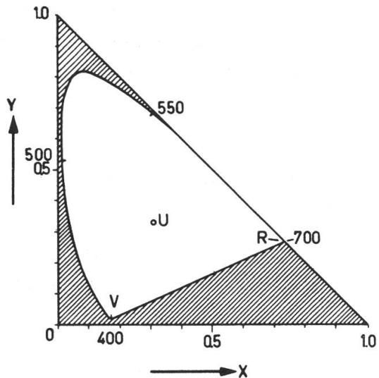
Die wenigen Hinweise zur Farbmehrheit zeigen ihr Prinzip und weisen den Weg der Praxis andeutungsweise. Ihr Zweck ist, zu zeigen, dass eine objektive Messung der Farbe möglich ist mit Hilfe eines geeigneten Photometers. Eine subjektive Methode, mit der ein geschultes Auge bemerkenswerte Ergebnisse erreichen kann, ist der Farbvergleich mit der Farbtafel, z. B. der von OSTWALD.
