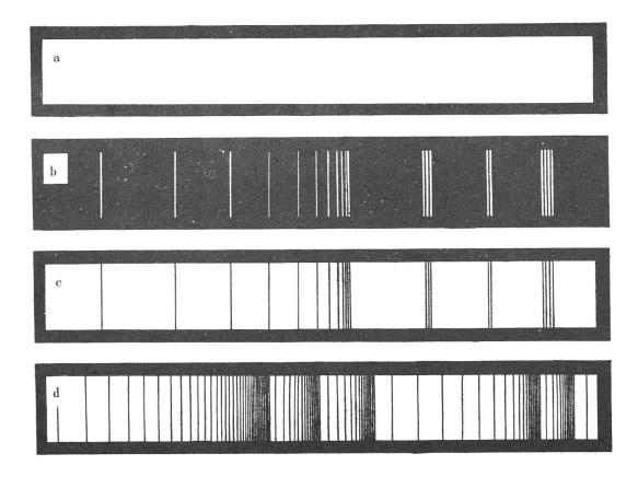
Abbildung 2-a) kontinuierliches Spektrum eines glühenden Körpers. b) Emissionslinienspektrum eines glühenden Gases. c) Absorptionslinienspektrum desselben Gases wie in b). d) Bandenspektrum eines Moleküls (in Absorption).
