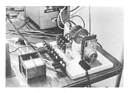
Abbildung 3 - Steuermechanismus zur Jupitermond-Kamera.
