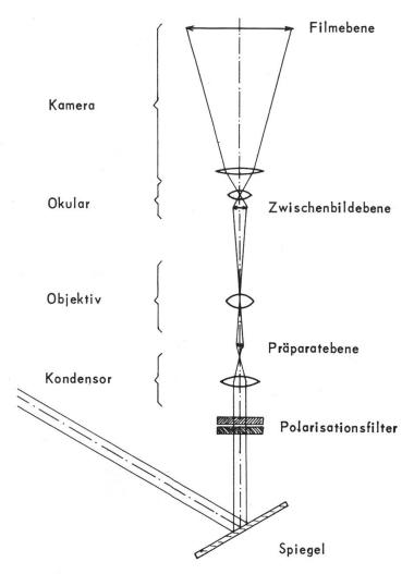
Schematischer Strahlengang durch das Mikroskop
