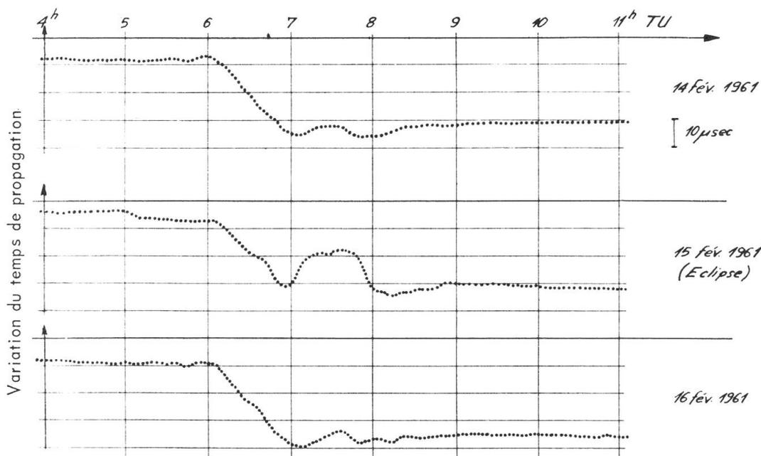
perturbations causées par les jets de corpuscules en provenance du soleil), on pouvait s'attendre à une variation du temps de propagation des ondes émises par l'émetteur GBR (Rugby, Grande-Bretagne) due à l'éclipse de soleil du 15 février.
