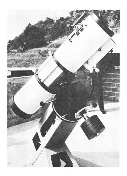
Abbildung 4-Das schöne Hauptinstrument der Sternwarte «Calina», ein Spiegelteleskop von 30 cm Oeffnung. Am obern Ende des Instrumentes erkennt man einerseits den Okularschlitten und den Sucher, anderseits das Leitfernrohr. (Photo R. A. Naef, nach Negativ einer Farbaufnahme.) Weitere Aufnahme auf Umschlag.
