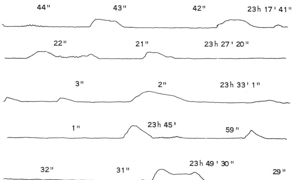
Le cliché ci-dessus représente l'enregistrement graphique direct d'une émission de Spoutnik IV. Cet enregistrement a été réalisé à notre station le 1er juin 1960. Au cours de ce passage, les émissions furent enregistrées durant 44 minutes, soit de 23.09 h. à 23.53 h., à l'aide des appareils décrits plus haut. La durée des trois passages précédents avait été du même ordre de grandeur.
