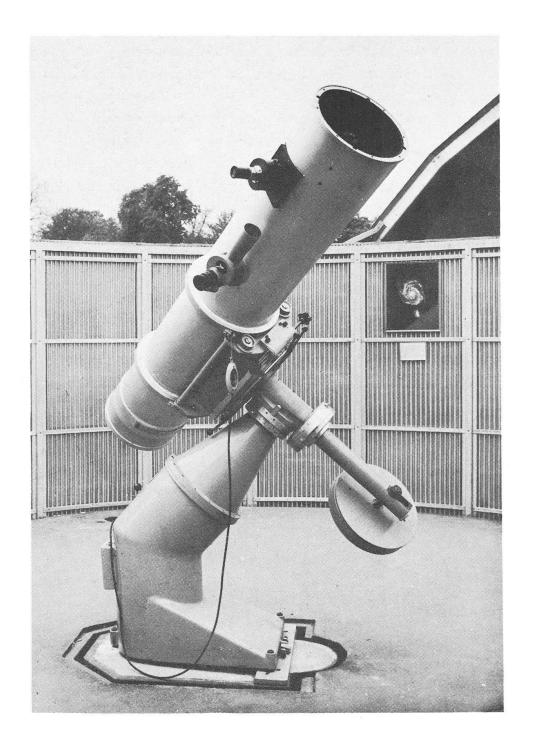
Abbildung 5-Spiegel-Teleskop Schaffhausen. Newton-Spiegel von 26 cm Durchmesser. Konstrukteur des Teleskops: H. Lustenberger. (Photo: E. Bührer.)
