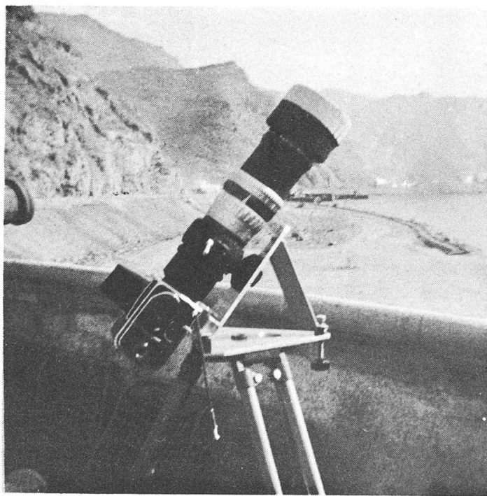
Abbildung 1 - Hasselblad-Kamera 1:3.5 mit Teleobjektiv Telastan 300 mm, die für die Korona-Aufnahme Abbildung 3 verwendet wurde. Beobachtungsort 1 km nördlich Santa Cruz de Tenerife. Im Hintergrund das in die Totalitätszone hineinragende Anagagebirge. (Photo: G. Widmer.)
