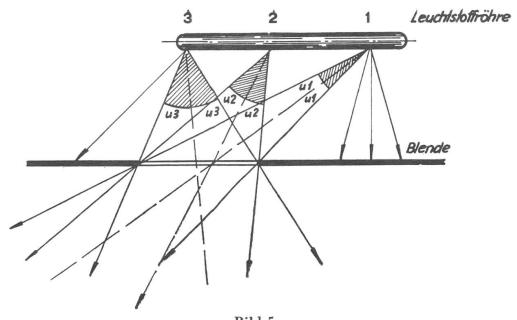
Bild 5 Strahlung einer Leuchtstoffröhre durch eine Blende
