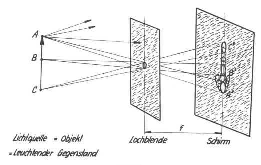
Bild 13 Prinzip der Lochkamera
