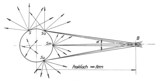
Bild 6 Strahlung einer praktisch unendlich fernen Lichtquelle (Sonne) endlicher Winkelgrösse  $\alpha$ . B = Beobachter.
