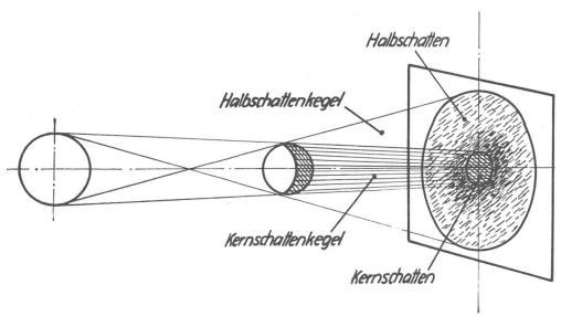
Bild 16 Schatten bei endlicher Lichtquelle
