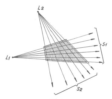
Bild 10 Zwei sich durchschneidende Strahlenbündel
