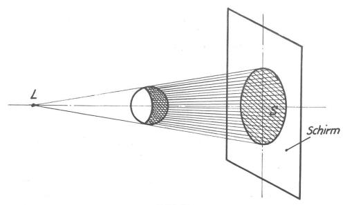
Bild 15 Schatten bei Punktbeleuchtung
