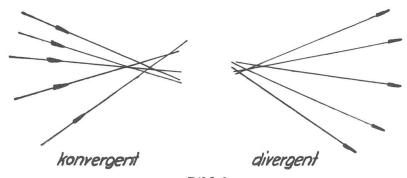
Bild 9 Nicht-homozentrische Strahlenbündel
