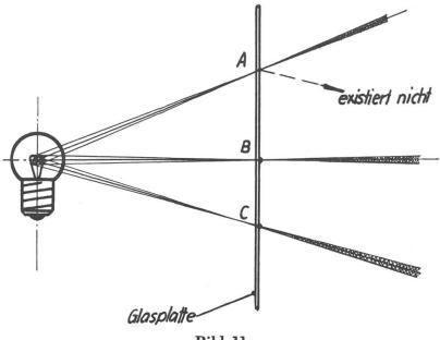
Bild 11 Beleuchtung einer Glasplatte
