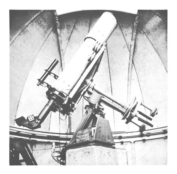
Abbildung 1 - Sphinx Observatorium der Hochalpinen Forschungsstation Jungfraujoch (3570 m ü.M.). Table équatoriale mit 26 cm-Cassegrain Teleskop, an welchem der Quarzspektrograph montiert ist.
