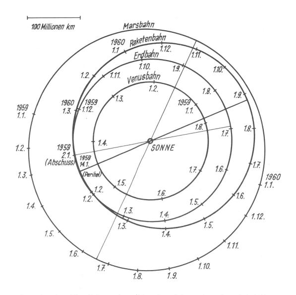
Die Bahn des künstlichen Planetoiden (bezeichnet als Raketenbahn) liegt grösstenteils zwischen der Erd- und Marsbahn. Nur in der Nähe des Perihels liegt ein kurzes Stück der Bahn innerhalb der Erdbahn.
