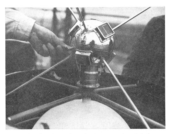
Der Versuchssatellit von 17 cm Durchmesser am obern Ende der dritten Stufe der Vanguard-Rakete
