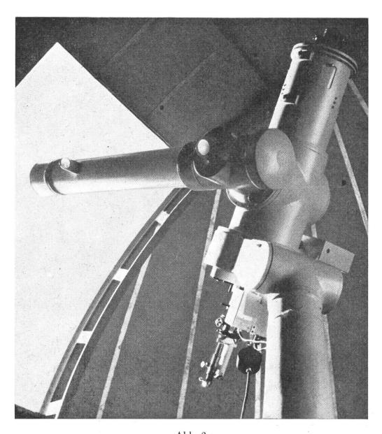
Abb. 2 Der Coudé-Sonnenrefraktor der Specola Solare. Am oberen Ende der Stundenachse der H $\alpha$ -Monochromator, am untern das Protuberanzenspektroskop
