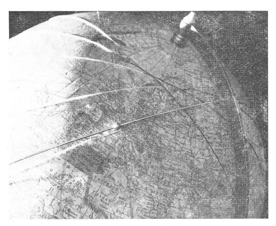
Projektion von Durchflügen der Trägerrakete (1957  $\alpha_1$ ) auf die Erdoberfläche für den 24. Okt. 1957
