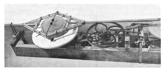
Gestänge mit den 4 Puffern und den auf dem Spiegel liegenden Tragrollen. Spann- und Tragrollen für die Transmission sind gut sichtbar, ebenso rechts ein Teil des Exzenters mit verstellbarem Hub und einstellbarem Gestänge. (Ausführung exzentrischer Striche.)
