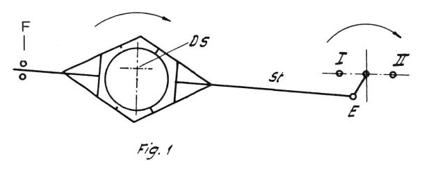
Die Schleifschale rotiert auf einer langsam drehenden Unterlage mit Drehpunkt DS (Fig. 1). Der Spiegel wird in einem Gestänge über die Schleifschale geführt. Das Gestänge gleitet auf der linken Seite in einer Führung F und wird auf der rechten Seite durch den Exzenter E angetrieben. Die Länge des Stange St und der Hub des Exzenters E sind in den nötigen Grenzen verstellbar. Der Spiegel liegt mit verstellbarem Spiel zwischen vier Bolzen.
