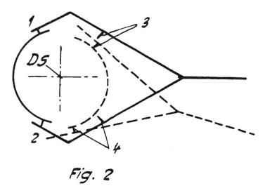
Dass der Spiegel immer durch ein Bolzenpaar an der Stirnseite gestossen wird, wirkt sich beim Polieren günstig aus.
