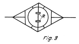
Das Gestänge hängt in der richtigen Höhe an einer Querstange mit zwei Rollen R (Fig. 3). Die Rollen hinterlassen, wenn aus Metall, auf dem Glas einen unschönen Ring und sollen deshalb mit einem Stück Gummischlauch überzogen sein.
