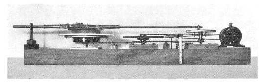
Seitenansicht der Schleifmaschine. Vom Motor rechts wird über eine Saite die grosse Riemenscheibe (Nähmaschine!) angetrieben. Mit ihr fest verbunden ist das obere Kettenrad zur Uebertragung der Drehung auf die Exzenterwelle rechts. Von dieser aus wird über eine Untersetzung (lose auf der mittleren Achse) der Schleifteller (links) in langsame Rotation versetzt.
