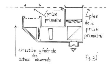
En particulier, il semble bien que tous les télescopes et interféromètres, optiques ou radioélectriques, admettent comme prise primaire une portion de surface plane placée devant leur ouverture libre et la recouvrant complétement.
