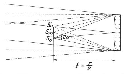
Fig. 5 Abbildung eines praktisch unendlich fernen Gegenstandes endlicher Winkelgrösse
