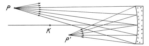
Fig. 2 Abbildung eines Punktes (K = Kugelmittelpunkt)
