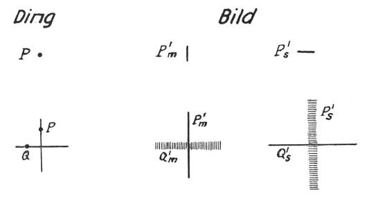
Fig. 10 Astigmatisches Bild eines Kreuzes
