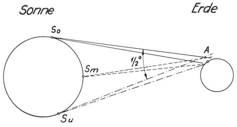
Fig. 4 Strahlung einer praktisch unendlich fernen Lichtquelle
