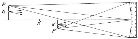
Fig. 3 Abbildung eines Gegenstandes
