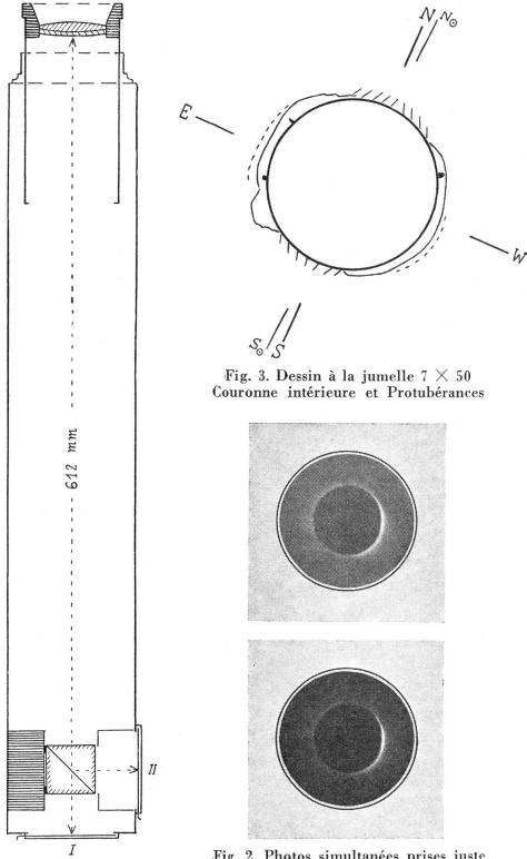
Fig. 1. Appareil à double image: directe I et réfléchie II
