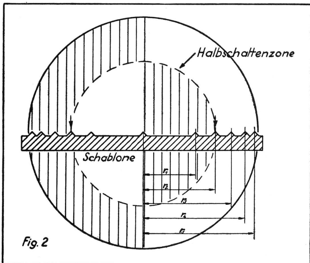
Man kann nun durch folgendes Vorgehen die Zonenprüfung, die bei grossen Differenzen bzw. Öffnungsverhältnissen unumgänglich wird, stark vereinfachen: Bewegt man die Schneide mittels einer Schraube der bekannten Ganghöhe  $g$  in gleichmässigen Intervallen aus dem Krümmungsmittelpunkt der Spiegelmitte vom Spiegel weg, so wandern die den jeweiligen Krümmungsradiendifferenzen  $d$  =
