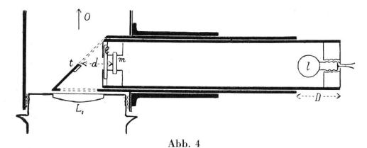
Das visuelle Planetenphotometer, das zur Messung des Erdlichts im Monde verwendet wurde. l, Lampe; t, helles Schirmchen; m, Streuglas; e, Blaufilter;  $L_1$ , Okularlinse. Durch Abstandveränderung der Lampe bzw. des Streuglases wird auf Helligkeitsgleichheit von Schirm und Mondrandstelle eingestellt.
