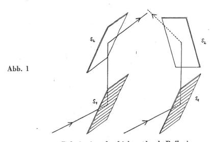
Polarisation des Lichtes durch Reflexion
