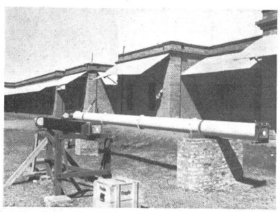
Abb. 1 Die beiden Horizontalkameras von 2.5 und 8 m Brennweite in Finsternisstellung.
