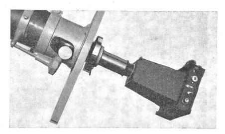
Abb. 5. Die am Okularende des 135 mm Refraktors befestigte Photokamera.
