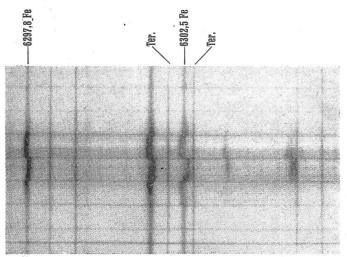
Abb. 2. Zeeman-Effekt im Spektrum eines starken Sonnenflecks. Die Linie λ 6302.5 A.E. zeigt eine Aufspaltung nach dem Schema unserer Abb. 1 C mit richtiger Polarisation der Komponenten, wodurch die Anwesenheit eines nordpolaren Magnetfeldes von etwa 3000 Gauss nachgewiesen wird.
