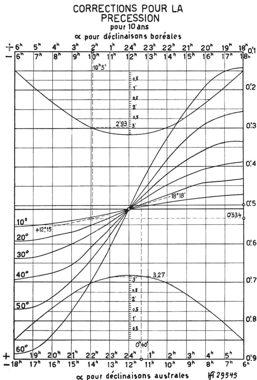
de ce point on trouve sur l'échelle verticale de droite la valeur de 0 m 534 (pour 10 ans). Multiplié par 220 on obtient 1 h 57 m. La position en ascension droite de *Regulus* dans 2200 ans sera donc: 10 h 5 m + 1 h 57 m = 12 h 2 m.
