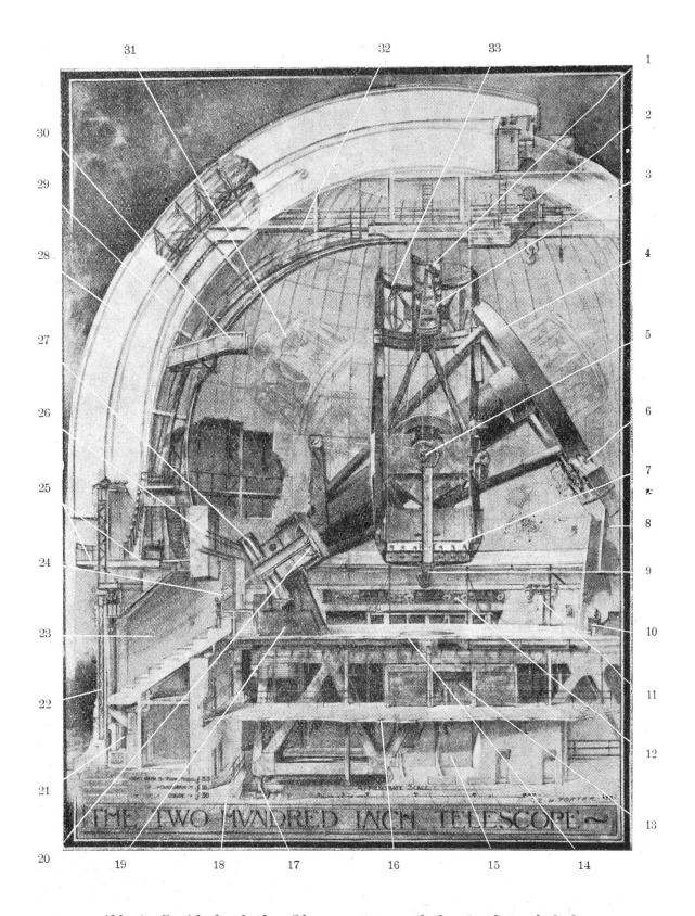
Abb. 3 Profil durch das Observatorium und das 5-m-Spiegelteleskop.
