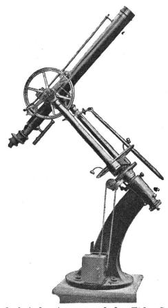
Abb. 2 Das Fraunhofer'sche Aequatoreal der Eidg. Sternwarte, Zürich, zur Bestimmung der Sonnenflecken-Relativzahlen
