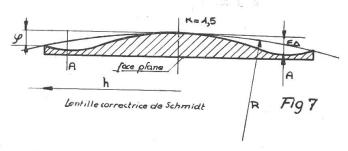
Ce premier rodage devra être fait avec des carborundums fins (350, 500, 800) et le rayon de courbure constamment mesuré avec un bon sphéromètre permettant des lectures voisines du micron. Le rayon de courbure de la lentille correctrice est calculé avec une approximation suffisante par la relation:
