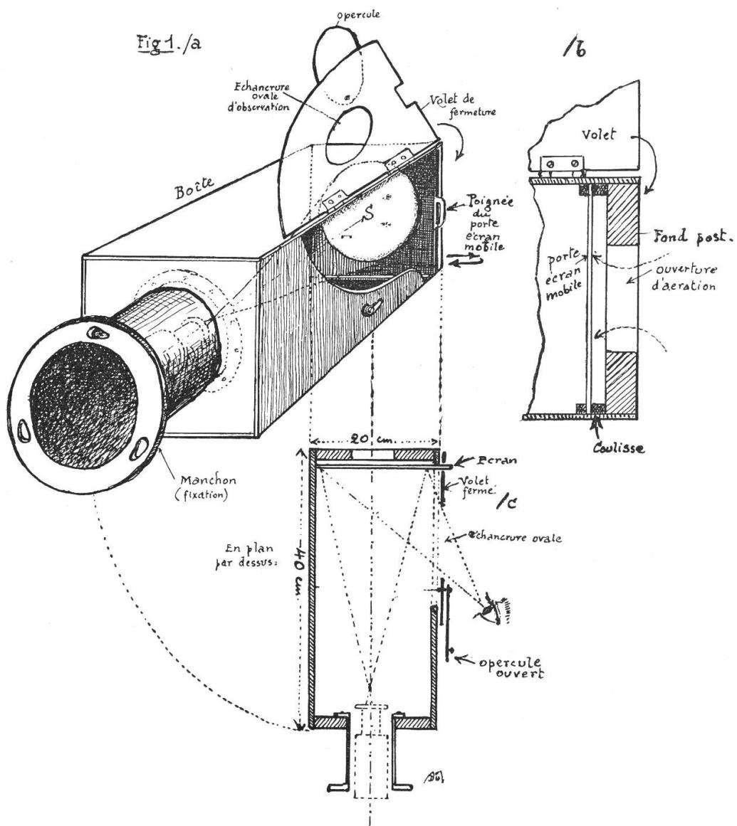
une coulisse et de venir occuper sa place de fond, bien perpendiculaire à l'axe de la boîte et à l'axe optique prolongé de la lunette. On construit ainsi une chambre noire au fond de laquelle l'image solaire vient se projeter avec un contraste splendide qui prend
