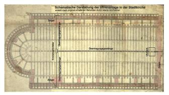
So dürfte die Uhrenanlage, eingetragen in den originalen Plan der Balkenlage auf dem Kirchen-Estrich von Blasius Baltenschwiler, funktioniert haben.
